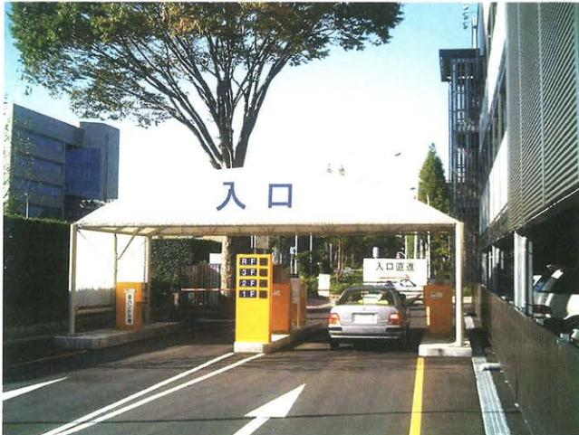
屋外の入出庫口の防雨テント。雨天時のカード破損、機器故障を防止する。
