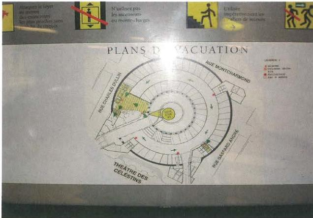
内部構造図。外側螺旋が入庫用走路。内側螺旋が出庫用走路。
