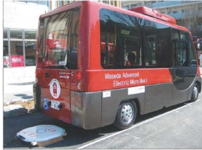
図 31 非接触型充電システム
