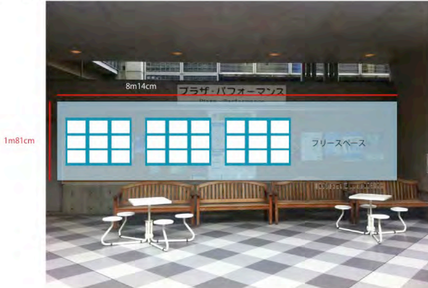
はねあげ式 B0パネル 3台 幅1,548×縦1,122×厚さ44.5(mm) 有効画面寸法1456×1030(mm) 1台につき、画用紙八つ切り (271mm×391mm) が最大 9 枚掲示可能。
